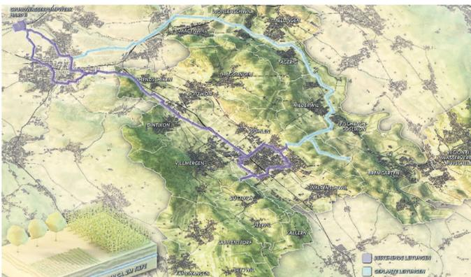
Der projektierte Wasserring. Die Leitung im Bünz (vom Pumpwerk Hard bis Wohlen) besteht bereits, nun wird der Ring mit einer neuen Leitung durchs Reusstal vollendet.
